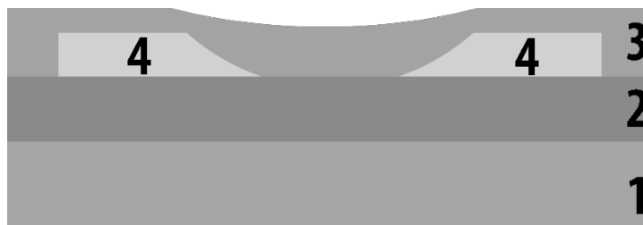
Рис. 4.5. Схематическое изображение экспериментальной ячейки. 1 – подложка (стекло); 2 – первый полимерный слой; 3 – второй полимерный слой; 4 – медные электроды;
