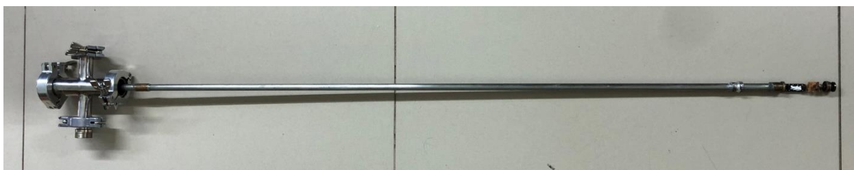
Рисунок 2.2 — Температурная вставка для измерения электросопротивления/магнитосопротивления.
