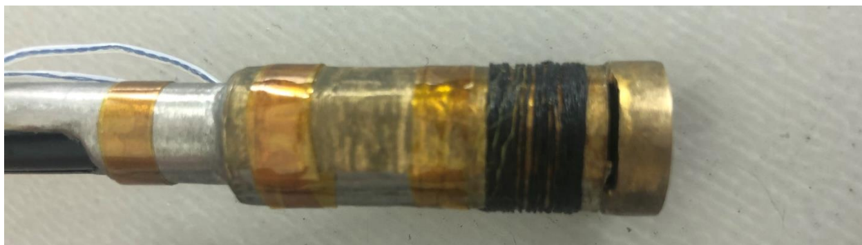
Рисунок 2.4 — Нижняя часть температурной вставки.
