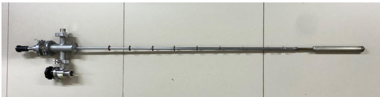
Рисунок 2.6 — Температурная вставка для измерения теплопроводности.
