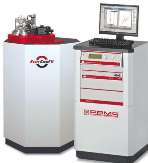
Рис. 2.9. Внешний вид комплекса для исследования физических свойств материалов в широком диапазоне температур и магнитных полей PPMS-9 + EverCool-II Quantum Design.
