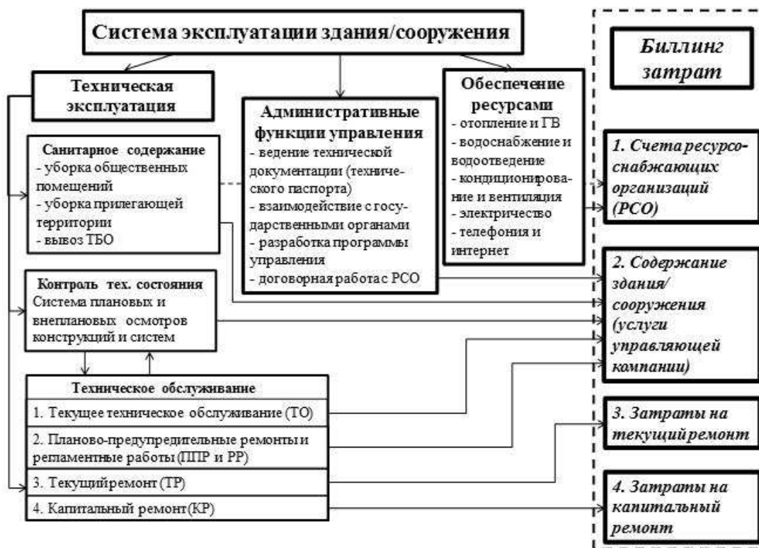
Рис. 3. Система эксплуатации здания/сооружения
