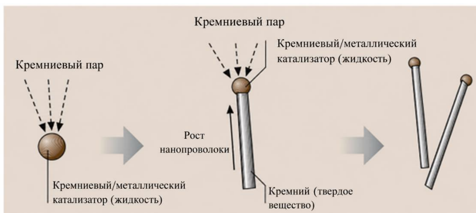
Рисунок 1.1. – Схематичное изображение механизма роста нанопроволок с использованием метода «пар–жидкость–кристалл» [44]
