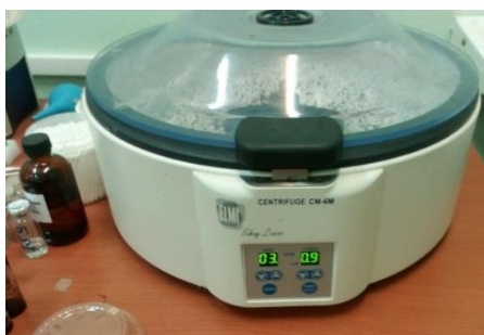
Рисунок 14. Спин-коатинг. Центрифуга CM-6M
