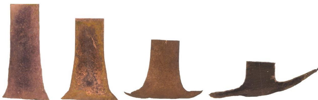
Рис. 1.2. Сечения медных образцов после удара с различными начальными скоростями: а — 162 м/с; б — 225 м/с; в — 316 м/с; г — 416 м/с [33].
