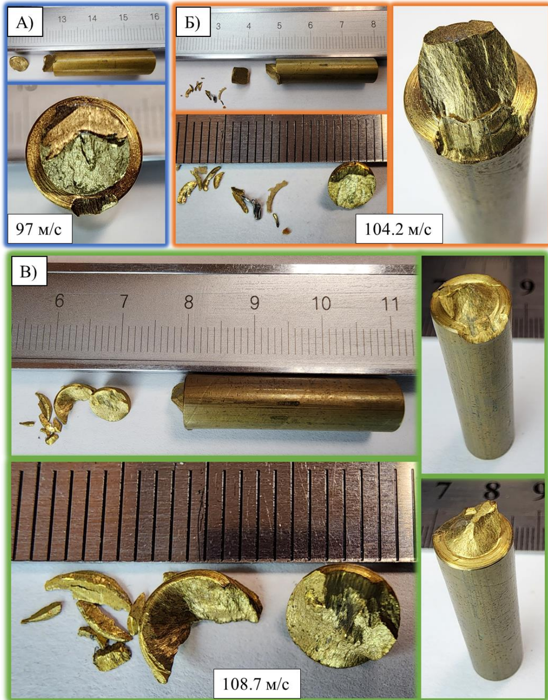
Рис. 3.6. Результаты экспериментов: Финальная форма разрушенных образцов и осколки при различных скоростях удара для 4-мм цилиндров.
