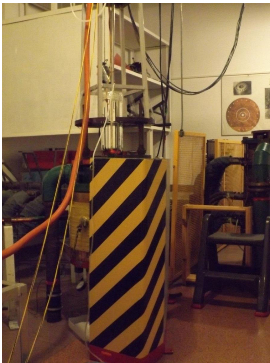
Рис. 2.13. Биттеровский магнит E-150 с установленным в его рабочую область калориметром для измерения МКЭ вблизи комнатной температуры.
