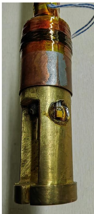
Рисунок 2.3 — Нижняя часть температурной вставки.
